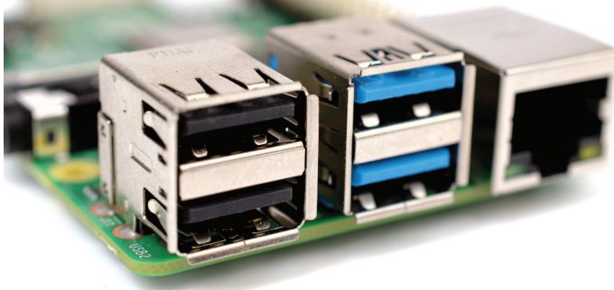
Рис. 1.6: USB-порты платы Raspberry Pi
