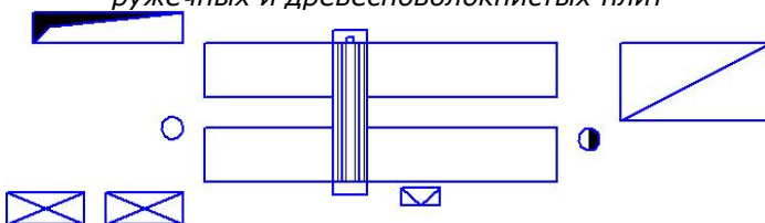
Рис. 2.8. Организация рабочего места станка ЦРЛ20-1 для раскроя стружечных, волокнистых плит, фанеры, бумажно-слоистого пластика и заготовок древесностружечных необлицованных и облицованных плит на детали чистовых размеров
