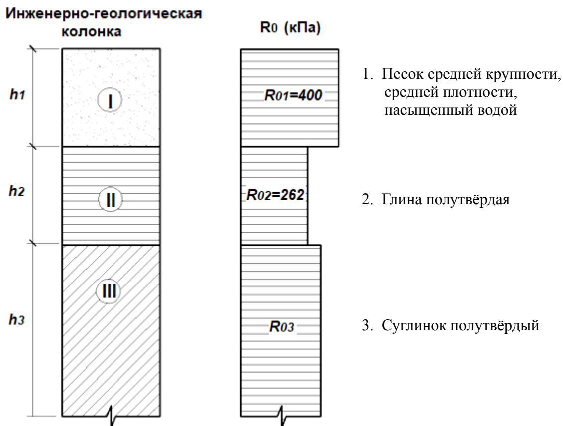
Рис. 1.2. Инженерно-геологические условия основания сооружения
