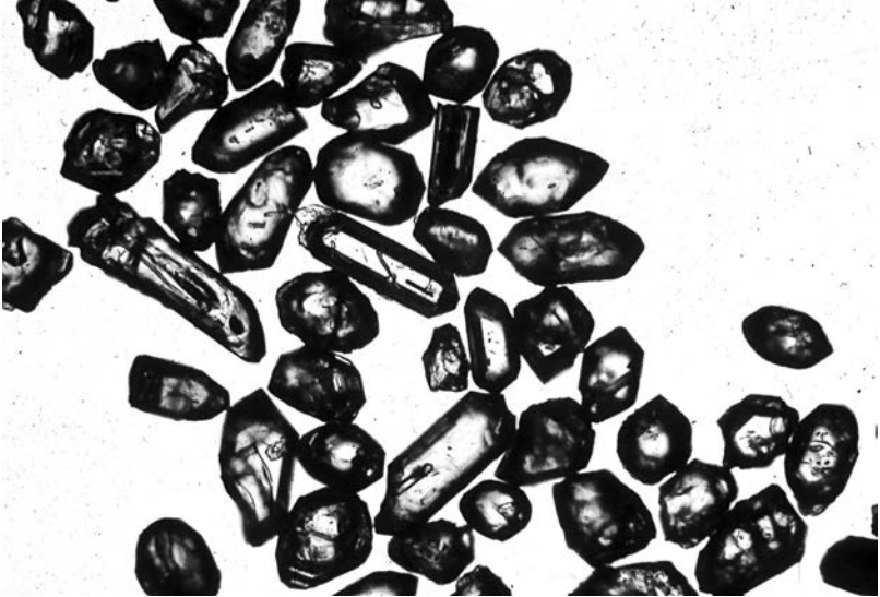
Рис. 1.2. Кристаллы циркона для определения радиометрического возраста; кембрий (530,7±0,9 млн лет); Восточный Ньюфаундленд, Канада (публикуется с разрешения Джозефа Киршвинка)
