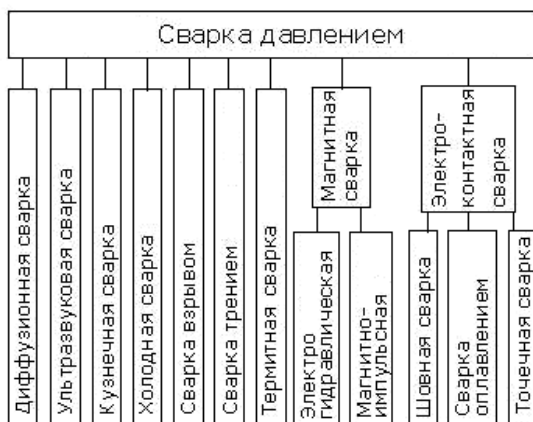
Рис. 1.5. Классификация основных способов сварки давлением
