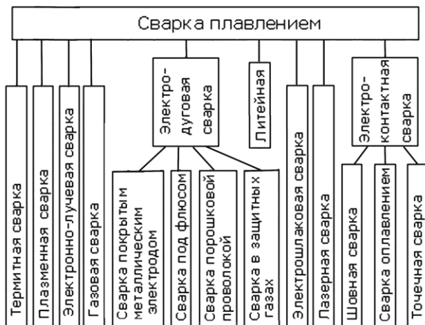
Рис. 1.4. Классификация основных способов сварки плавлением
