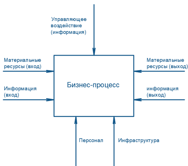
Рис. 1.1. Пример модели бизнес-процесса в нотации IDEF0
