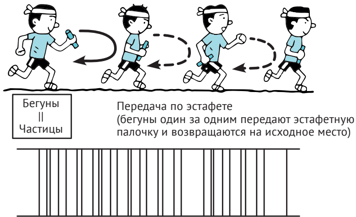
Рис. 2 Продольная волна? (колебания частиц параллельно направлению распространения волны)
