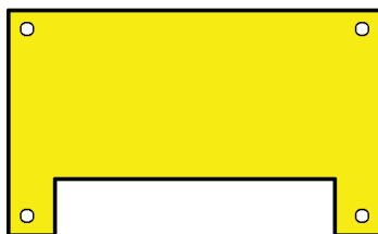
Рис. 2.3. Форма для демонтажа микросхем с количеством выводов от 20
