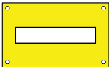
Рис. 2.2. Форма наконечников на жало для демонтажа радиоэлементов из плат
