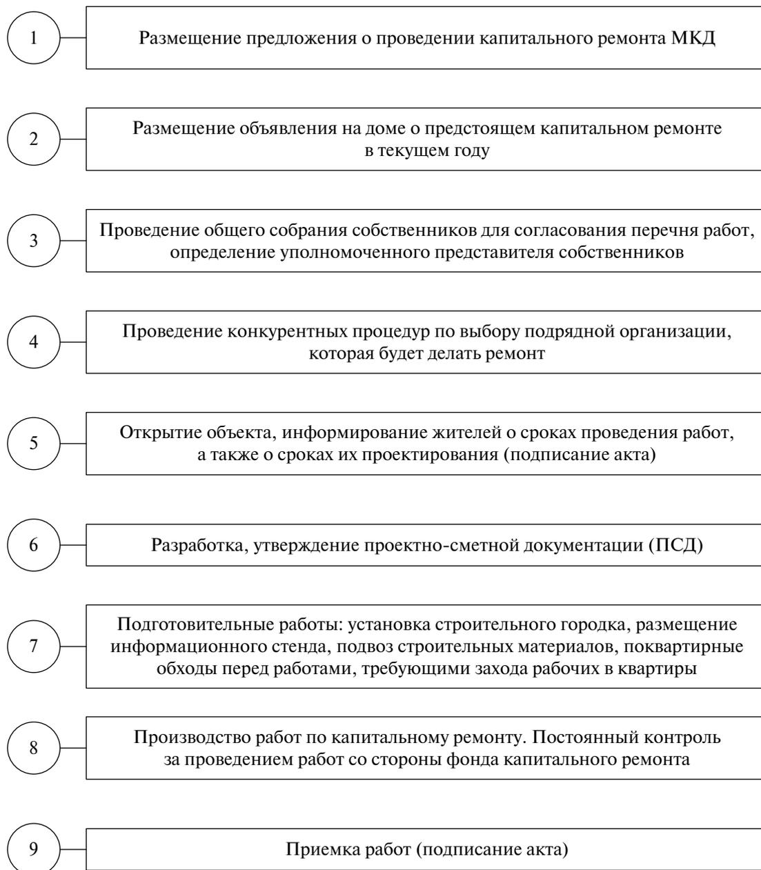
Рис. 1.2. Порядок проведения капитального ремонта
