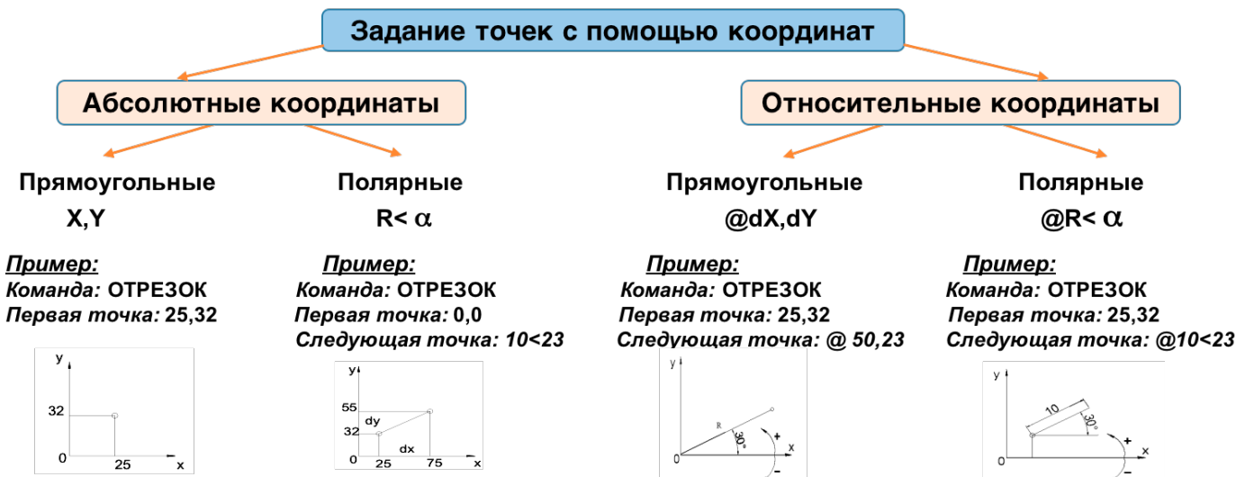
Рис. 1.16. Задание точек с помощью абсолютных и относительных координат
