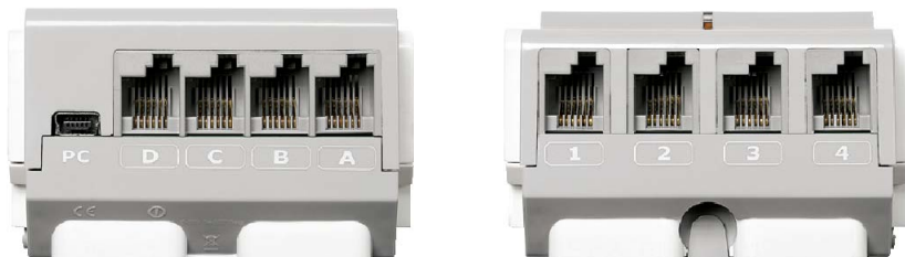
Рис. 1.3. Порты для подключения моторов (слева) и датчиков (справа)
