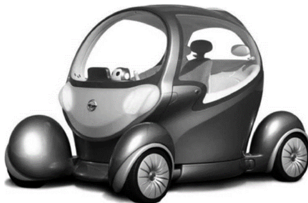
Рис. 3. Электромобиль с кабиной, вращающейся на 180°
