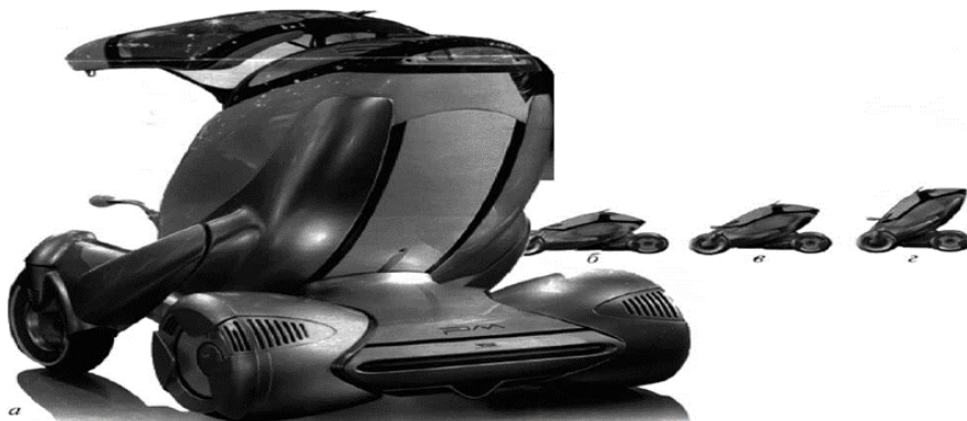
Рис. 1. Возможные положения кузова электромобиля Toyota PM
