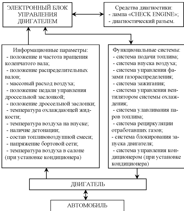
Рис. 1.1. Структурная схема электронной системы управления двигателем автомобиля
