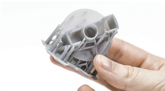
Рис. 0.6 ❖ Крышка торца вала после удаления с рабочей платформы со все еще прикрепленными поддержками
