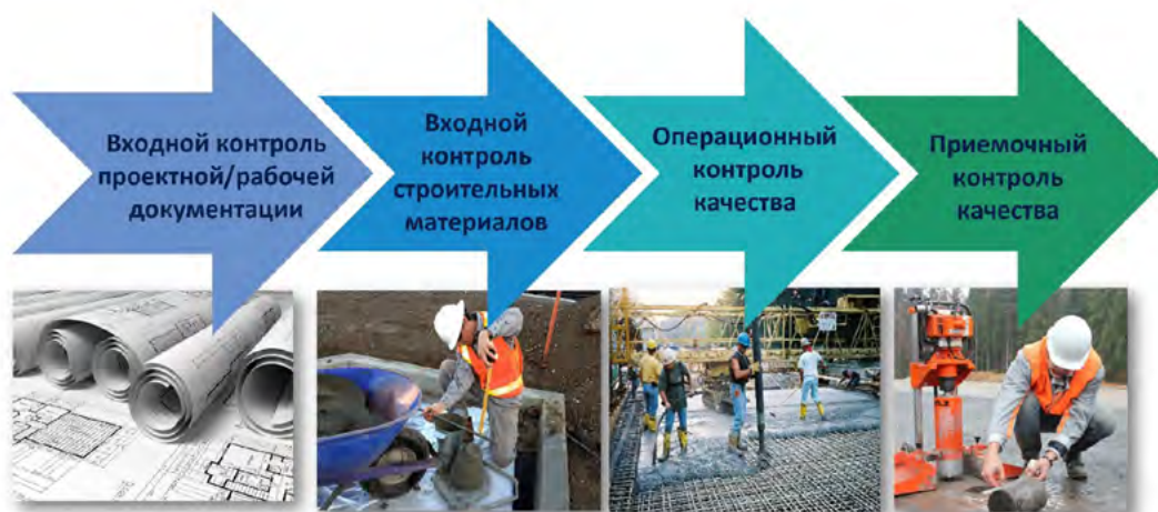
Рис. 2.1. Стадии строительного контроля на примере монолитных работ
