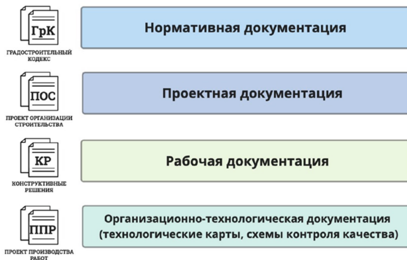
Рис. 1.1. Система документации, регулирующей строительный контроль
