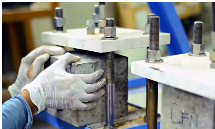
Рис. 1.4. Разрушающий контроль — испытание в лаборатории бетонных образцов
