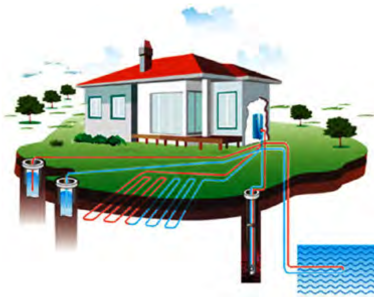
Рис. 2.1. Разновидности природных возобновляемых источников теплоты, используемых для ТН [13]
