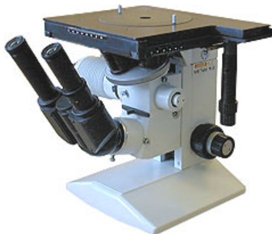
Рис. 1. Металлографический микроскоп ЕС МЕТАМ РВ
