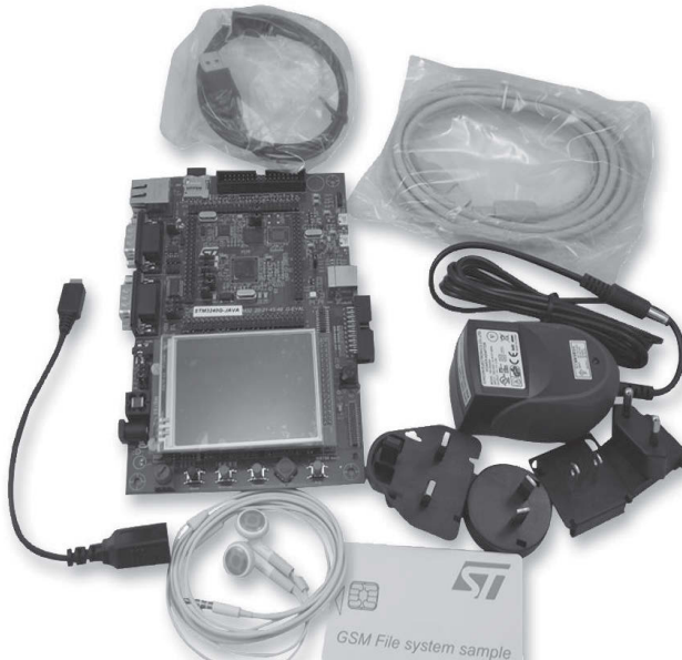
Рис. 1.4. Внешний вид стартового набора «STM3240G-JAVA» [1-9]
