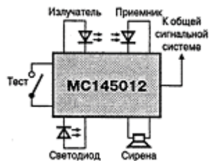
Рис. 1.3. Конструктивная схема включения инфракрасных датчиков – преобразователей сигнала
