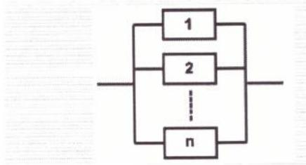
Рисунок 3 – Структурная схема системы при параллельном соединении элементов
