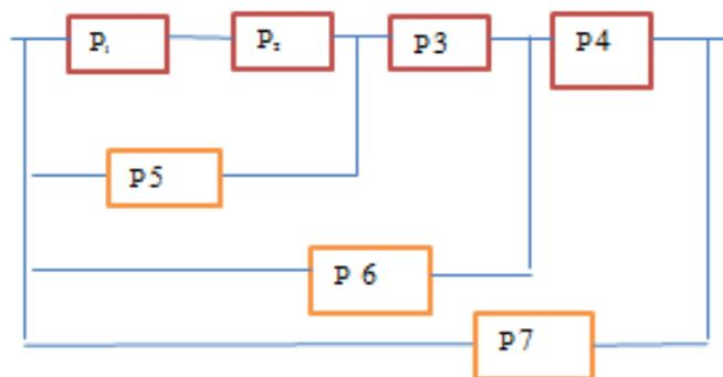
**Рисунок 5 – Надежность каждого элемента системы принять равной  $P_i = 0,9$**
