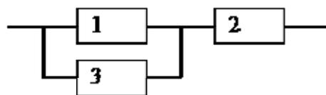
Рисунок 4 – Структурная схема системы при последовательно-параллельном соединении элементов
