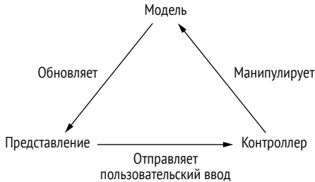
Рис. 1.1 Как работает паттерн MVC
