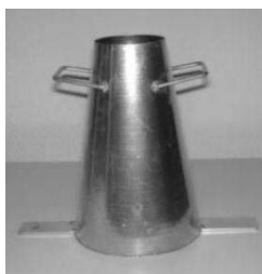
Рис. 1.1. Стандартный конус для определения подвижности бетонной смеси: 1 — ручка; 2 — корпус; 3 — упоры
