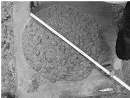
Рис. 1.3. Измерение расплыва конуса бетонной смеси в соответствии с ГОСТ 7473-94
