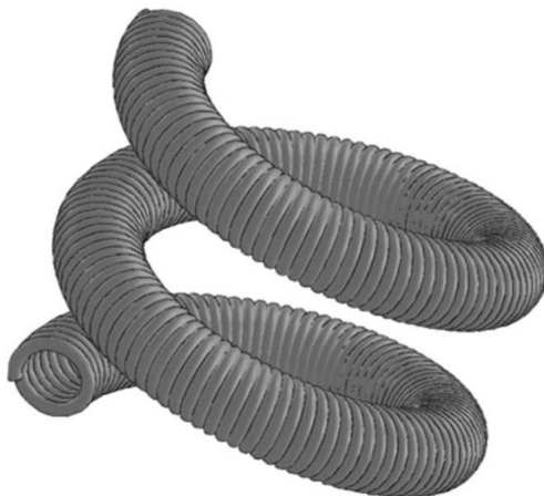
Рис. 1.9. Змеевиковый теплообменный элемент на базе пружинно-витого канала
