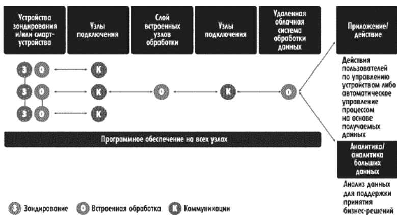
Рис. 3. Типовая архитектура IoT-решения (источник: Freescale Semiconductor)
