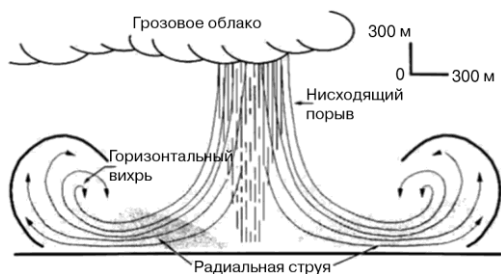
Рис. 1.9. Конвекция вниз тока, или нисходящий порыв
