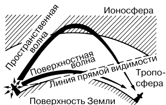
Рис. 2.3. Пути распространения поверхностной и пространственной электромагнитных волн
