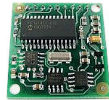
Рис. 1.8. Датчик компаса CMPS03
