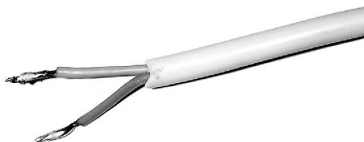
Рис. 9. Оплаивание электрических проводов перед подключением
