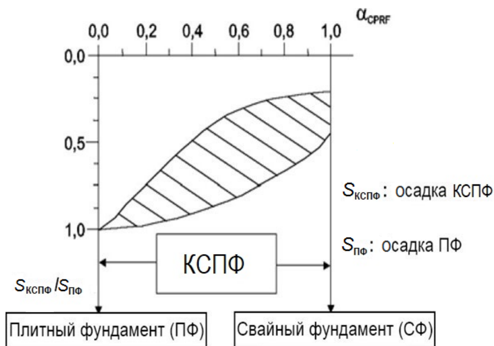
Рис. 9. Зависимости осадки комбинированного свайно-плитного фундамента ( S_{\text{КСПФ}}/S_{\text{ПФ}} ), отнесенной к осадке плитного фундамента, от коэффициента \alpha_{\text{CPRF}}
