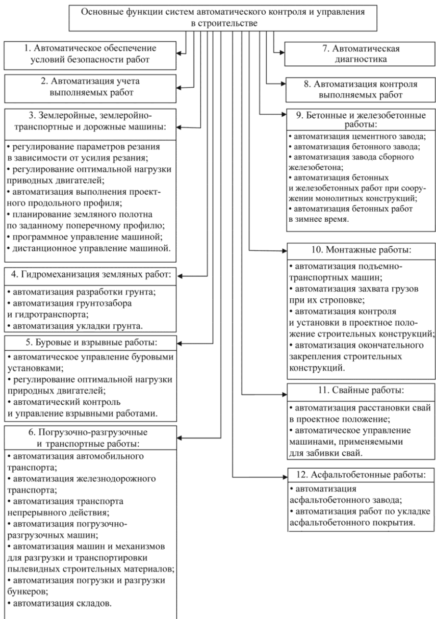
Рис. 1.2. Классификация автоматизированных строительных машин и механизмов
