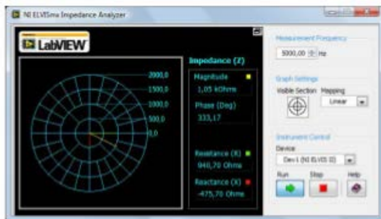
Рисунок 3.1 – Лицевая панель прибора Impedance Analyzer
