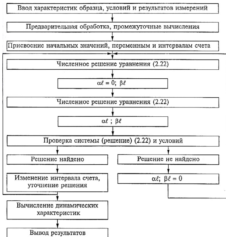
Рис. 2.4. Блок-схема программы вычисления динамических характеристик материалов рулонных покрытий пола по результатам измерений методом комплексного отношения ускорений
