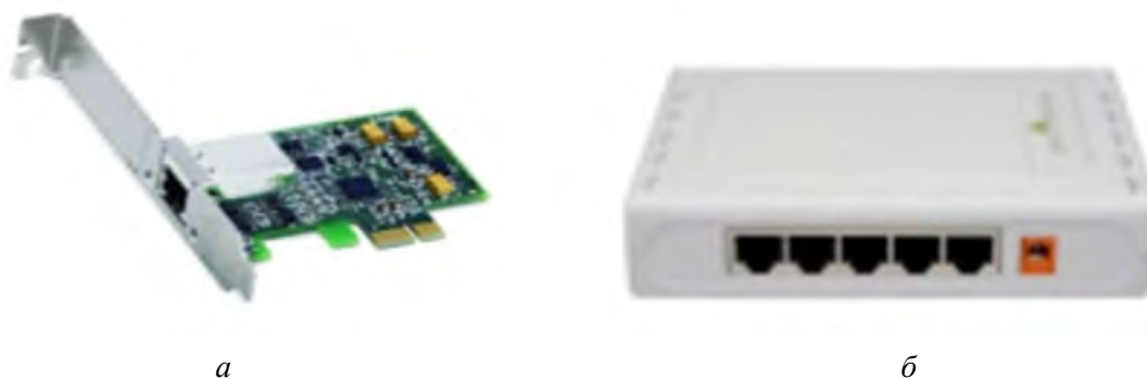
Рис. 1.2. Составные части сети стандарта Ethernet: а — сетевая плата; б — коммутатор
