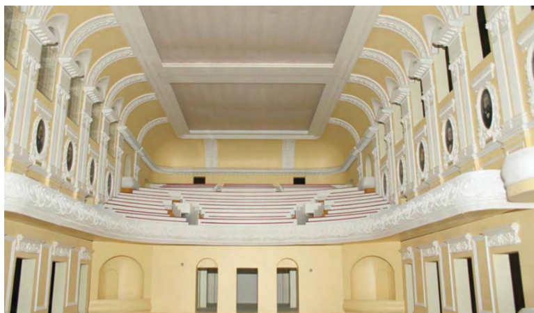
Рис. 2. Физическая модель Большого зала Московской консерватории, масштаб 1:20
