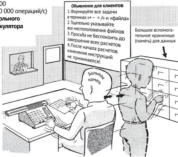
Рис. 1.1. Принцип работы цифрового компьютера с хранимой программой [Fruitt 1960]
