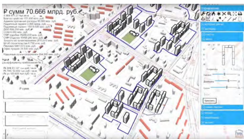
Рис. 1.8. Генерация вариантов застройки участка и подсчет ТЭП с помощью Робота R1 (разработка ООО «ПИК-Проект»)²
