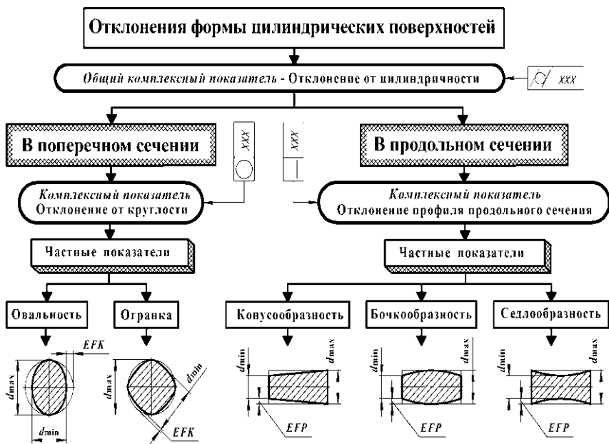
Рис. 8 — Отклонения формы цилиндрических поверхностей
