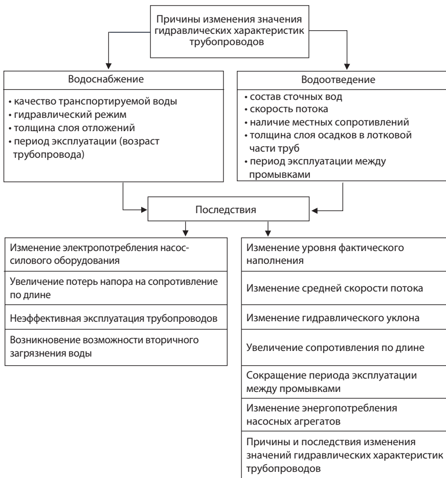
Рис. 1.5. Причины и последствия изменения значений гидравлических характеристик трубопроводов водоснабжения и водоотведения
