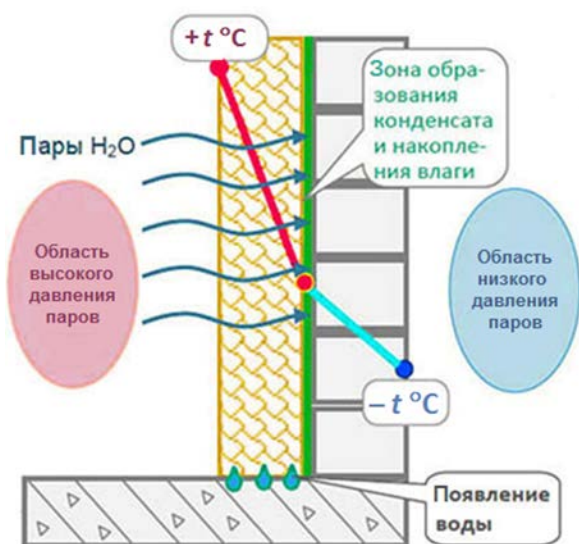
Рис. 3. Образование зоны конденсата в толще ограждения
