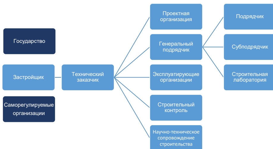
Рис. 1.1. Схема участников системы строительного контроля в строительстве
