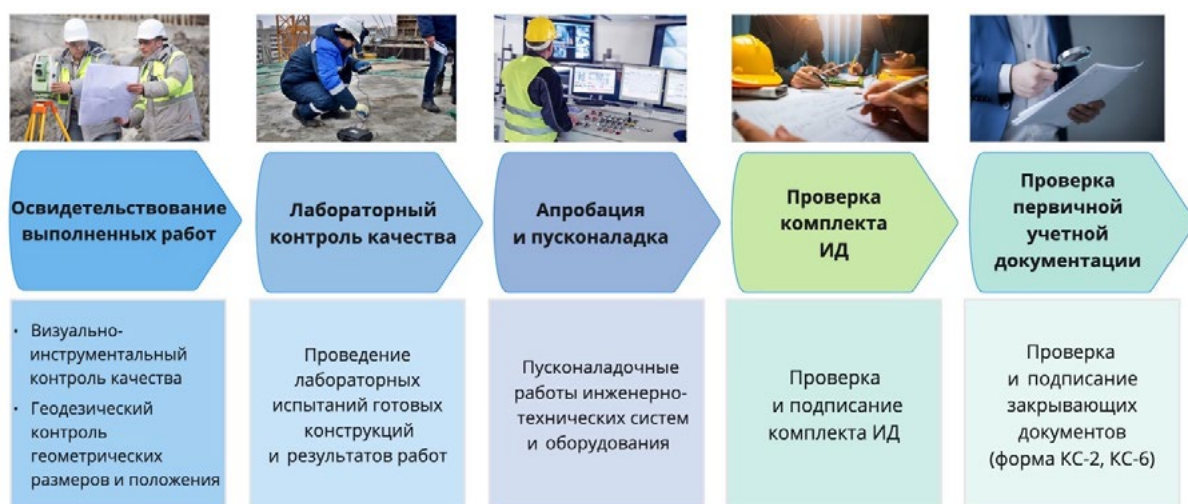
Рис. 2.4. Состав и последовательность процессов приемочного контроля
