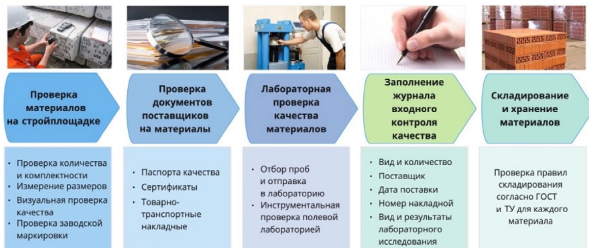
Рис. 2.1. Состав и последовательность процессов входного контроля качества материалов, изделий и оборудования
