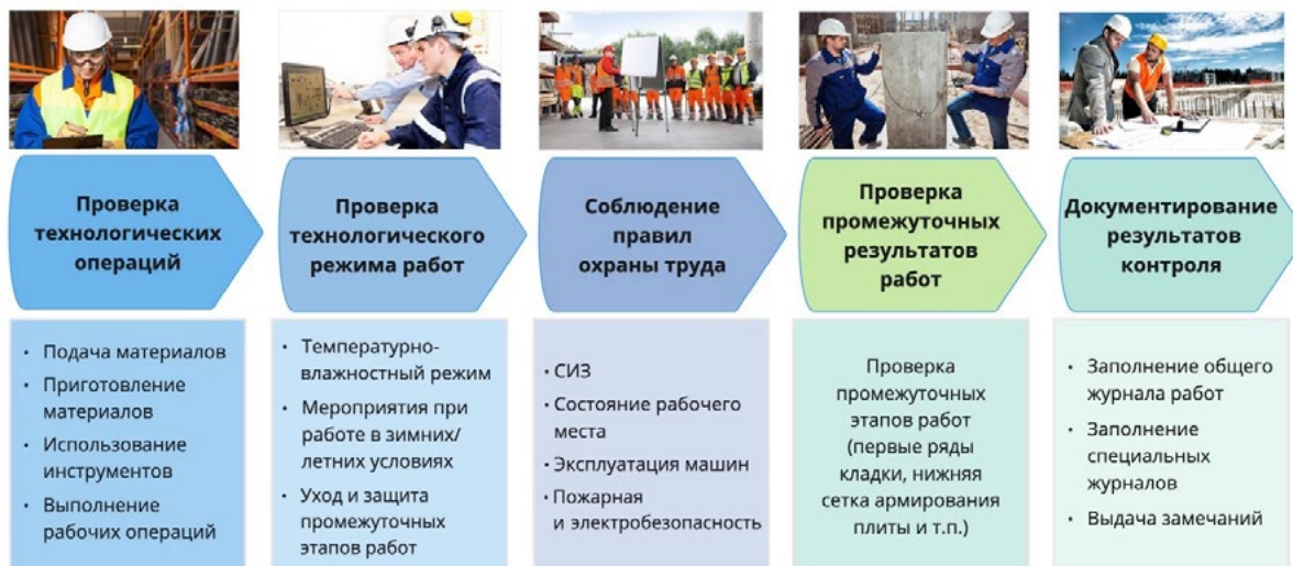
Рис. 2.2. Состав и последовательность процессов операционного контроля
