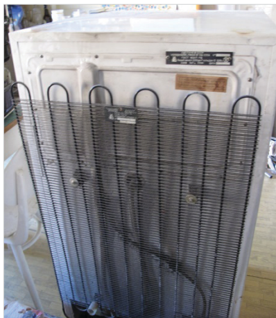
Рис. 2. Конденсатор на задней стенке холодильника
