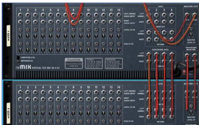
Рис. 1.8. Схема соединения двух микшеров в одну цепь
