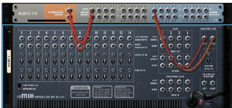
Рис. 1.4. Вид микшера с тыльной стороны
