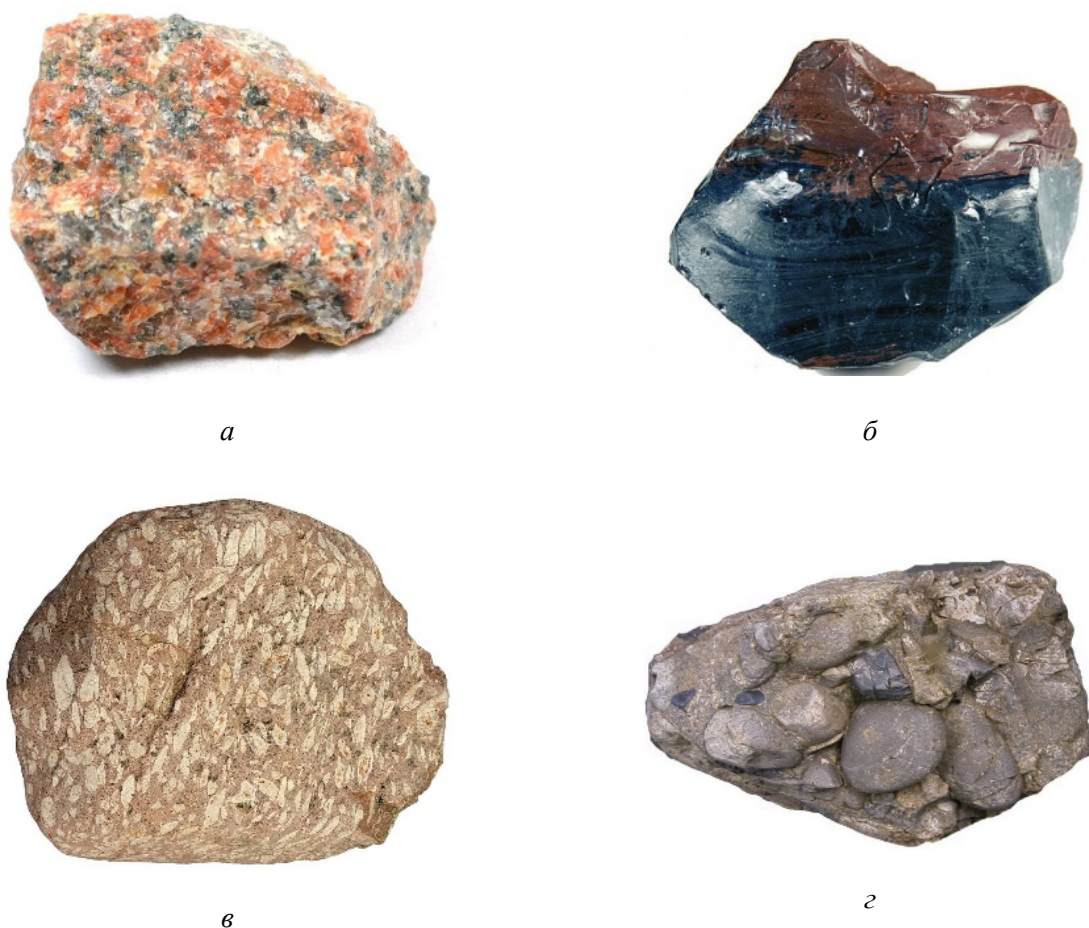
Рис. 1.1. Виды структур скальных пород: a — полнокристаллическая; неполнокристаллические: б — стекловатая; в — порфировая; г — обломочная
