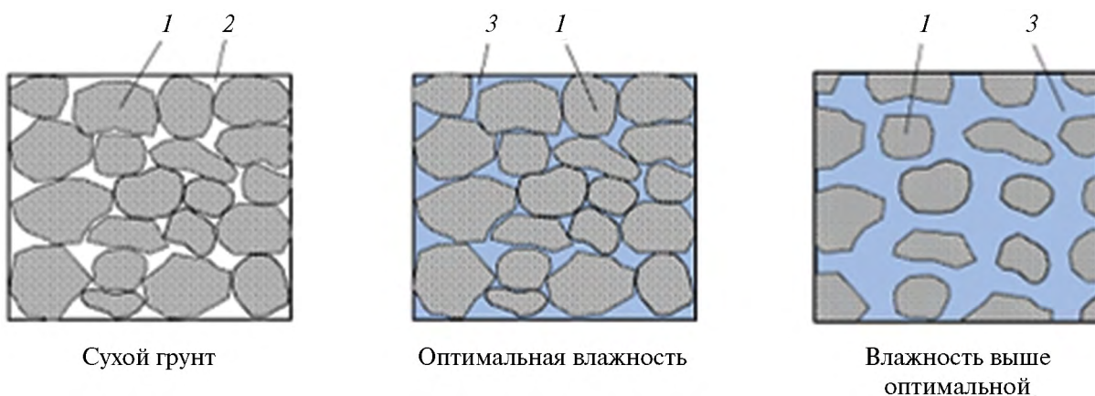
Рис. 1. Схематичное изображение компонентов грунта при различной влажности: 1 — частицы грунта; 2 — пустоты; 3 — влага
