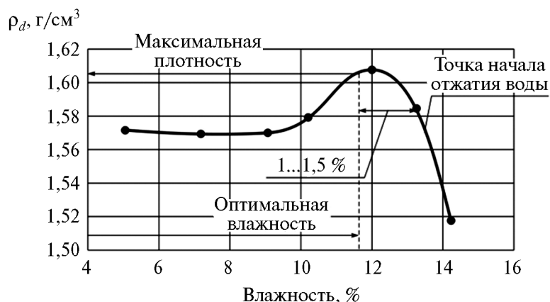
Рис. 4. Зависимость плотности сухого грунта от влажности
