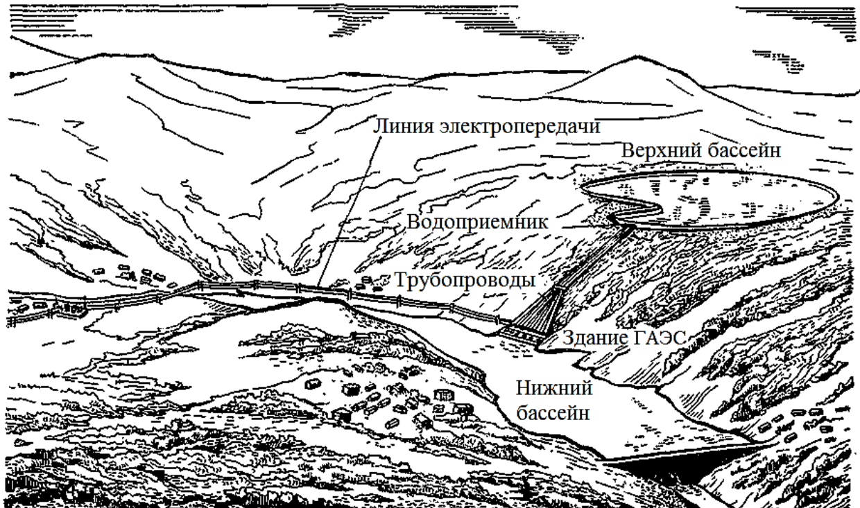
Рис. 1.2. Схема сооружений ГАЭС простого аккумулятивного типа с наземным расположением сооружений
