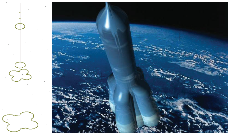
Рис. 1.3. Плоские фигуры для лофтинга и визуализация тонированной твердотельной модели ракеты
