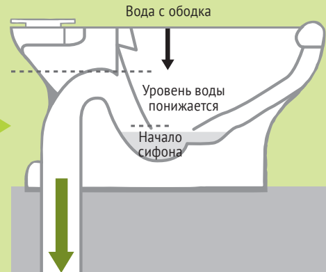
Уровень воды в унитазе становится ниже начала водораспределительной трубы
