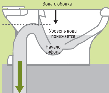
В результате действия сифона произошёл слив воды
