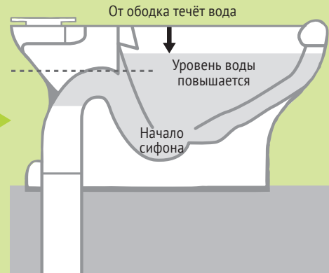
Состояние после того, как потянули за ручку и начала течь вода
