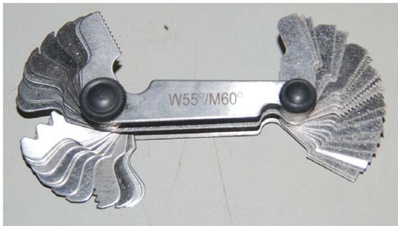
Рисунок 8 – Резьбомер метрический
