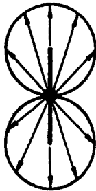
Рис. 20.11. Горизонтальная диаграмма направленности вертикально установленной рамочной антенны (вид сверху)
