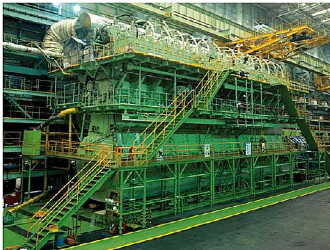
Рис. 1.2. 14-цилиндровый рядный малооборотный судовый дизель Wärtsilä-Sulzer RTA96 (отношение хода поршня S к диаметру цилиндра D S/D = 2500/960 мм, мощность N_c > 80\,000 кВт, частота вращения n = 102 мин -1 , рабочий объем V_h = 25\,480 л, масса 2300 т) 3
