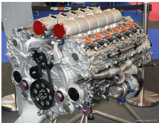
Рис. 1.3. 12-цилиндровый V-образный авиационный дизель RED A03 ( S/D = 88/85 мм, N_e = 370 кВт, n = 4000 мин -1 ) 4
